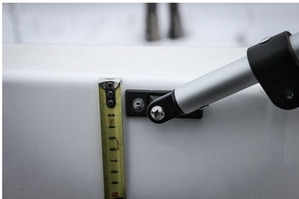
1. Установите кронштейн крепления дуг к корпусу лодки, (по центру кронштейна) от корпуса лодки со стороны кормы (см. рис). На нашем сайте, в разделе «инструкции» мы можете посмотреть фотографии размеров.
